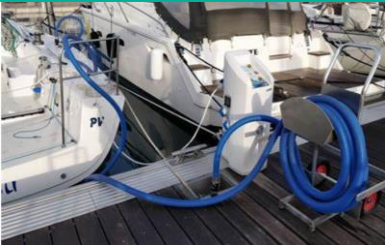
Equipement d'aspiration des eaux noires © internet
